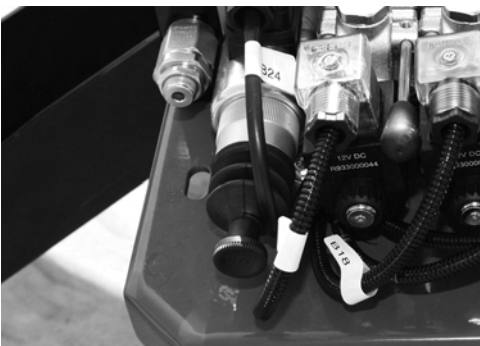
Fig. 169 Pommeaux d'activation de la vanne proportionnelle groupe chenillard
