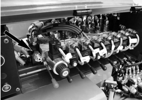
Fig. 8 Vanne de surpression de la partie aérienne
