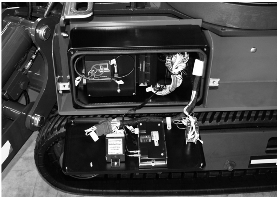
Fig. 30 Position de la carte électronique
