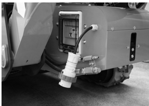
Fig. 102 Prise réseau électrique
