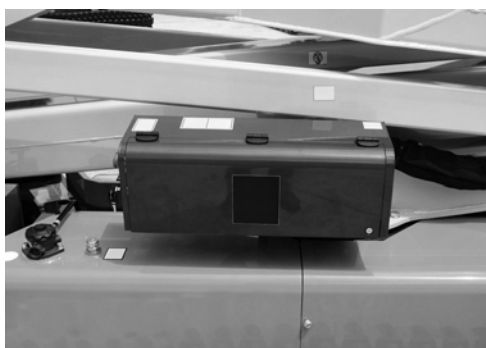
Fig. 152 Carter du distributeur de la partie aérienne
