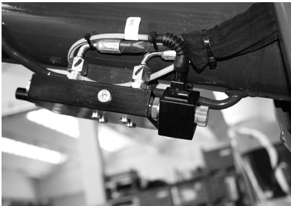
Fig. 87 Électrovanne pour la descente d'urgence par gravité
