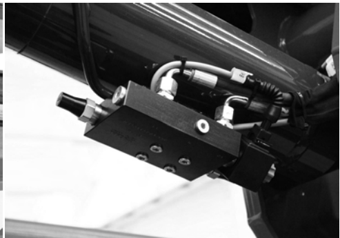
Fig. 11 Soupape d'arrêt des cylindres des bras
