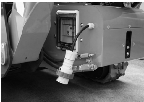
Fig. 173 Prise réseau électrique
