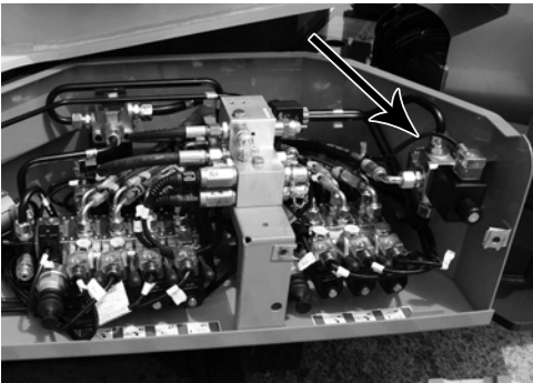
Fig. 168 Déviateur partie aérienne/groupe chenillard
