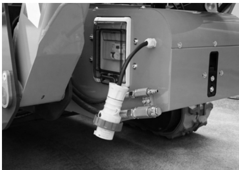
Fig. 175 Prise réseau électrique
