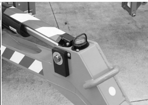
Fig. 121 Témoin de signalisation plateau au sol
