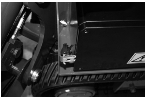
Fig. 145 Position de la clé d'urgence
