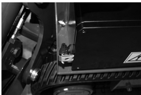
Fig. 151 Position de la clé d'urgence
