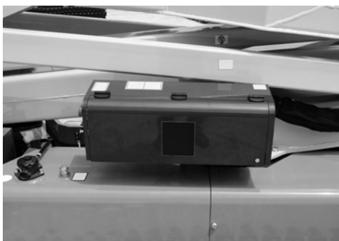
Fig. 140 Carter du distributeur de la partie aérienne
