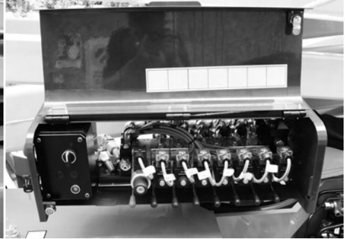
Fig. 78 Commandes hydrauliques au sol
