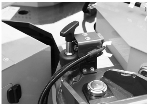
Fig. 110 Contrôle du blocage des stabilisateurs
