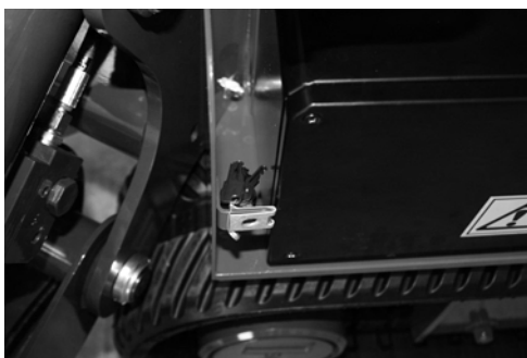
Fig. 139 Position de la clé d'urgence
