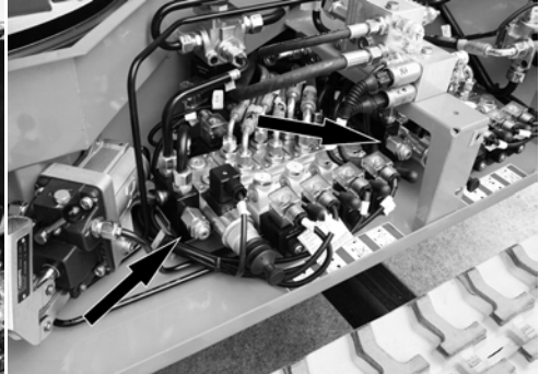
Fig. 9 Vanne de surpression du chenillard
