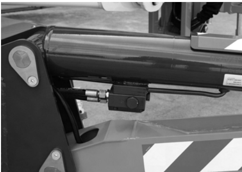
Fig. 10 Soupape d'arrêt des stabilisateurs
