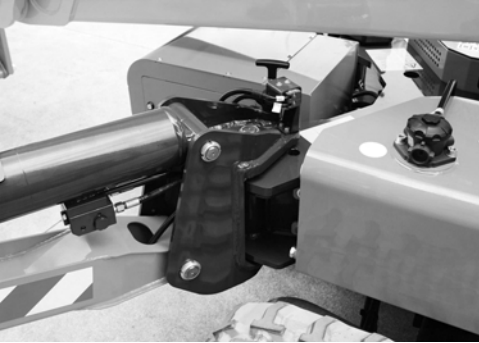
Fig. 107 Rotule des stabilisateurs
