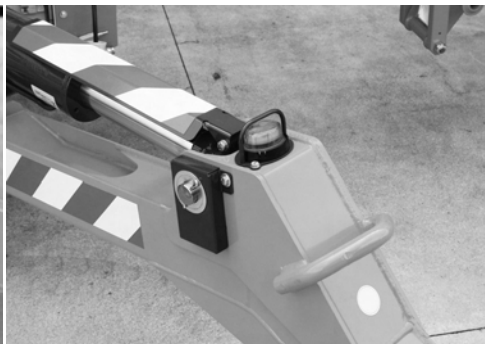
Fig. 15 Témoin de signalisation plateau au sol
