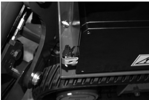
Fig. 161 Position de la clé d'urgence
