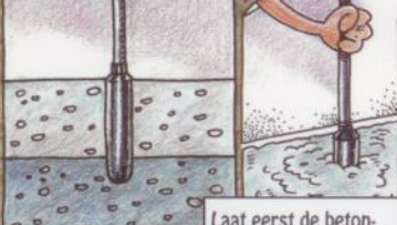
Laat eerst de betonspecie goed inklinken.
