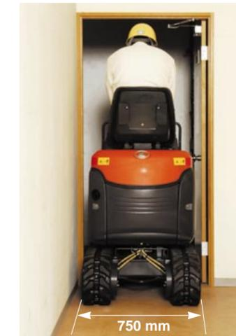
Lorsque la largeur du châssis est réduite à 750mm, la U10-3 peut passer par la plupart des portes facilitant ainsi l'accès à l'intérieur des bâtiments.
