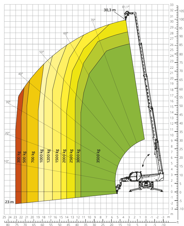
Abaque de charge avec TREUIL 3 500 kg ATT - 02 - 002
