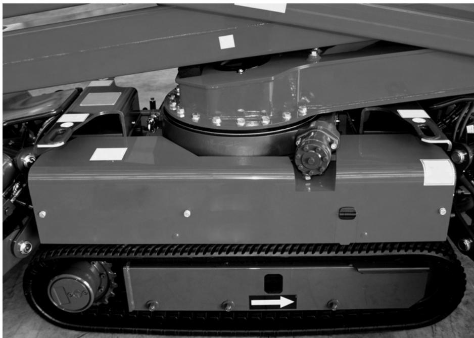
**Fig. 181** Points de levage avec fourches
