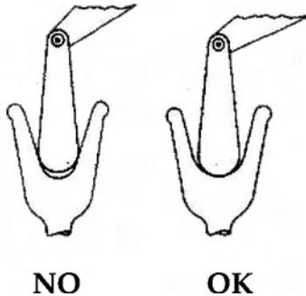
**Fig. 172** Exemple de contrôle de l'usure des poulies
