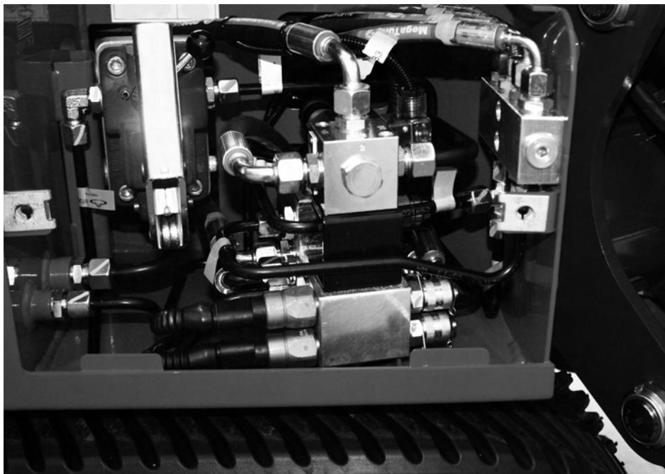
**Fig. 169** *Prises de pression sur la machine*
