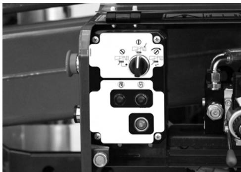
**Fig. 57** Sélecteur version avec moteur thermique
