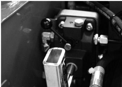
**Fig. 140** *Déviateur manuel de pompe manuelle*
