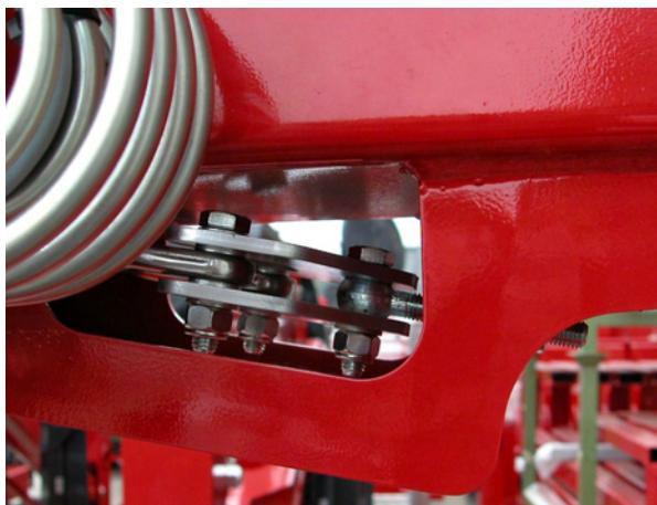
**Fig. 173** *Balancier de fixation des câbles de rétraction*
