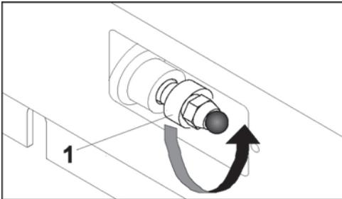
**Fig. 162** Vanne de tension de la chenille
