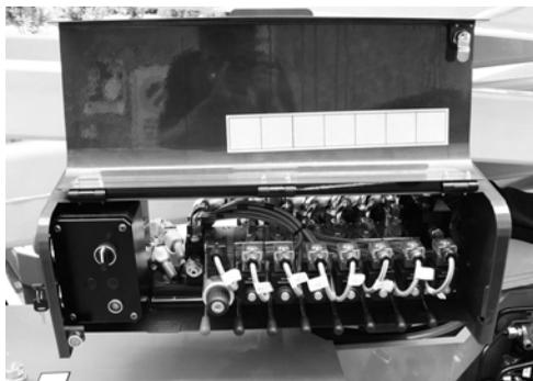
**Fig. 116** *Commandes sur le distributeur de la partie aérienne*
