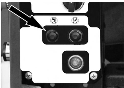
**Fig. 72** *Bouton de démarrage du moteur thermique*
