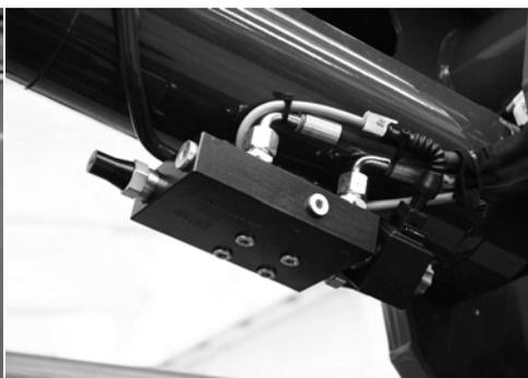
**Fig. 11** *Soupape d'arrêt des cylindres des bras*
