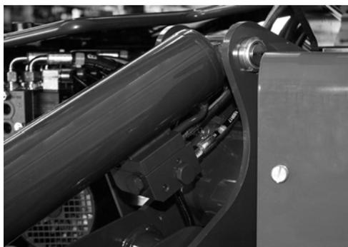
**Fig. 10** *Soupape d'arrêt des stabilisateurs*
