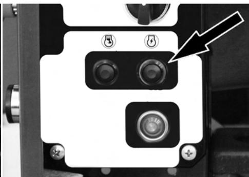
**Fig. 73** *Bouton de démarrage du moteur électrique*
