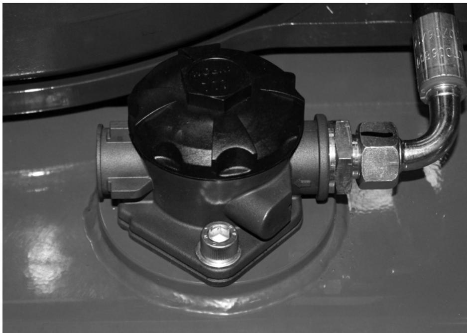
**Fig. 168** *Position du filtre à huile hydraulique*
