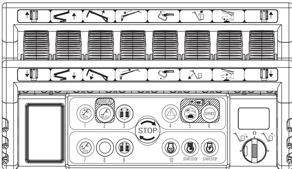
La télécommande contient la plupart des commandes de la machine pour un fonctionnement normal, elle est composée de boutons, joystick, sélecteur à clé, afficheur. La télécommande échange constamment des données avec la carte principale de la machine qui envoie les informations à afficher.
