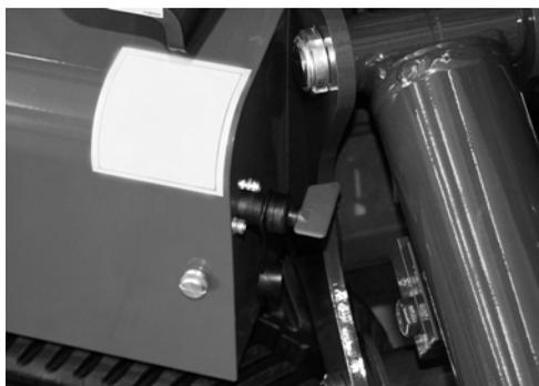
**Fig. 122** Coupe-batterie du moteur thermique
