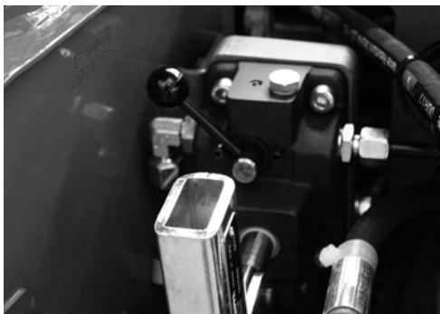
**Fig. 123** *Déviateur manuel de pompe manuelle*
