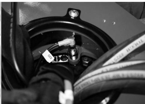
**Fig. 106** *Interrupteur sur sellette*
