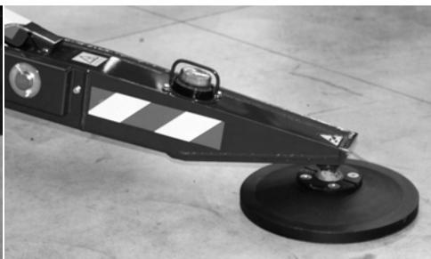
**Fig. 14** *Micro-interrupteurs des stabilisateurs*
