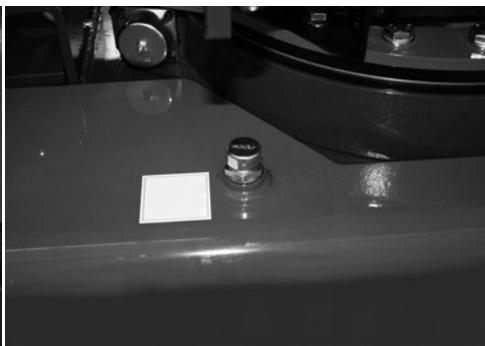
**Fig. 167** Bouchon de remplissage du réservoir à huile hydraulique
