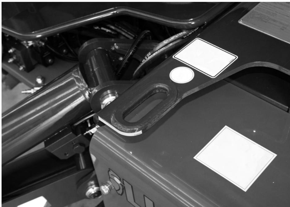
**Fig. 182** *Points de levage avec câbles ou chaînes*
