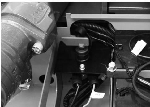
**Fig. 7** Coupe-batterie version lithium
