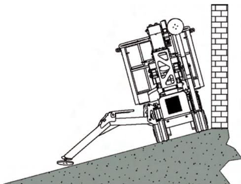
L'inclinaison maximale en translation figure parmi les caractéristiques techniques de la machine "Données techniques (p. 18)". Au cours des phases de translation sur un terrain incliné, abaisser les stabilisateurs en aval en les positionnant à proximité du terrain comme une ultérieure sécurité, en cas de variations soudaines de l'inclinaison.
