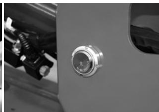
**Fig. 27** *Ring-écrou de blocage*
