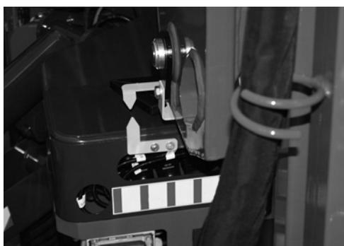
La fermeture complète et l'alignement de la machine sont indiqués par les flèches appliquées sur la machine et par l'icône n° 6 de la télécommande "Fig. 41 Partie aérienne fermée et alignée(p. 58)".
