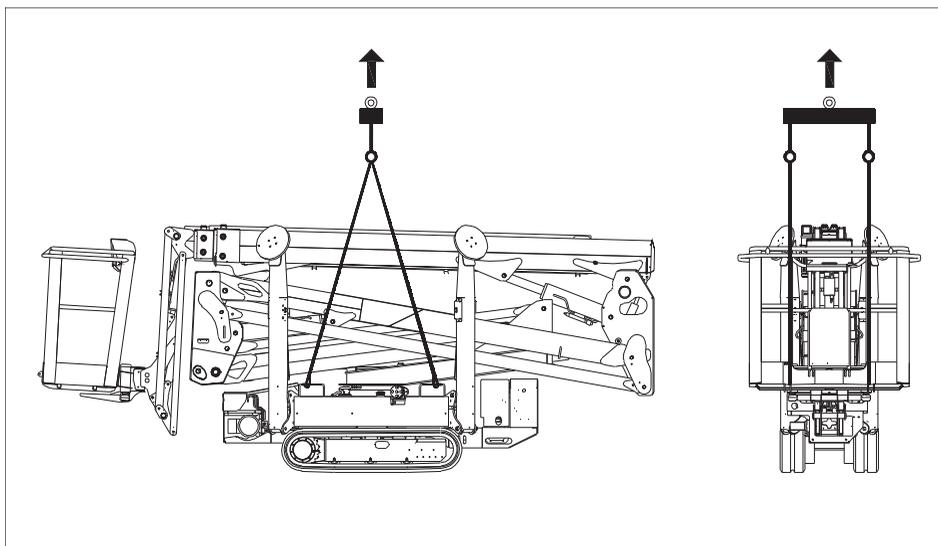
**Fig. 183** Schéma de levage avec câbles ou chaînes
