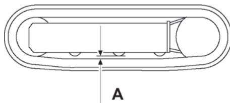
**Fig. 160** Contrôle de la tension des chenilles 1
