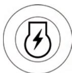
Il permet le démarrage/arrêt du moteur électrique. Si le bouton est enfoncé quand le moteur est allumé, on commande son arrêt.
