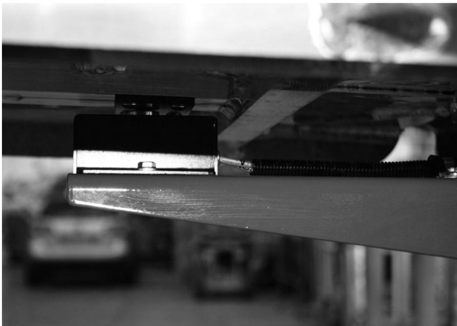
**Fig. 20** *Capteur de charge*
