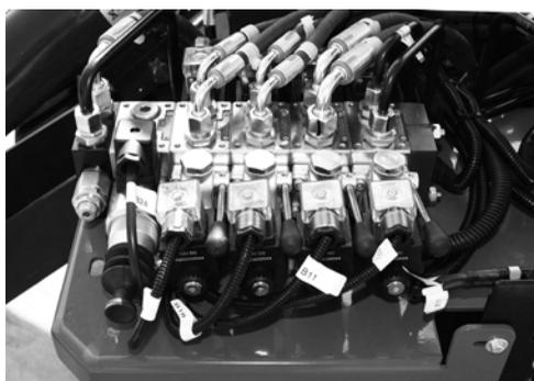
**Fig. 78** Commandes sur le distributeur gauche
