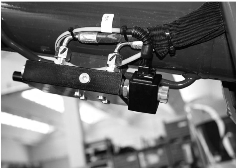
**Fig. 69** *Électrovanne pour la descente d'urgence par gravité*
