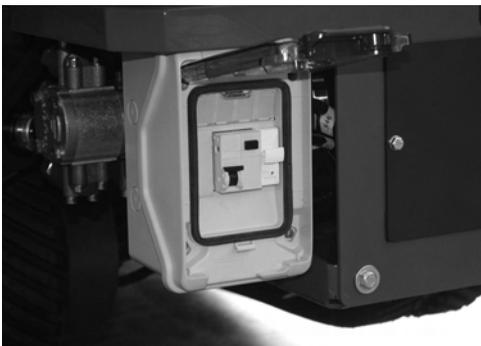
**Fig. 147** *Interrupteur automatique magnétothermique*
