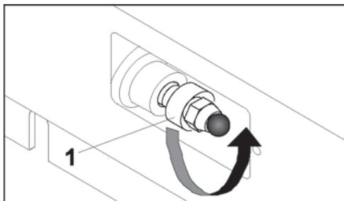
**Fig. 163** Vanne de tension de la chenille
