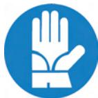
Gants de protection des mains conformes à la norme EN 60903, pour la protection et l'isolement pendant les travaux sur les parties sous tension.
