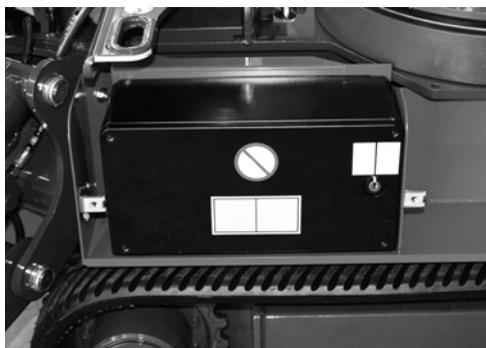
**Fig. 128** Boîtier électrique à l'intérieur du compartiment des composants électriques.
