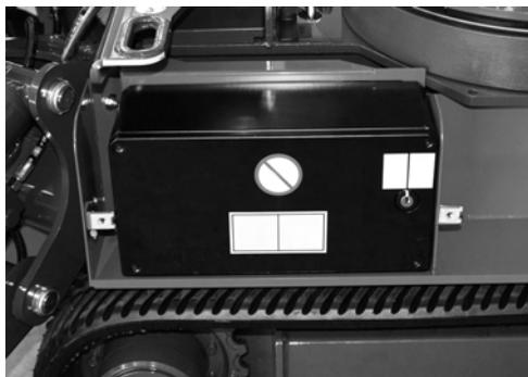
Fig. 133 Boîtier électrique à l'intérieur du compartiment des composants électriques.
