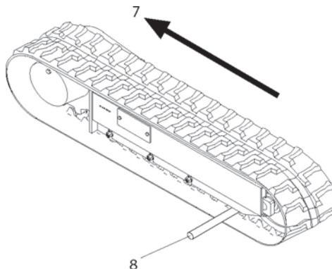
**Fig. 165** Exemple de montage de la chenille
