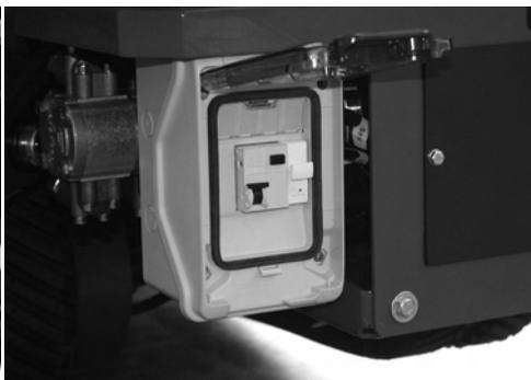
**Fig. 85** *Interrupteur automatique magnétothermique*
