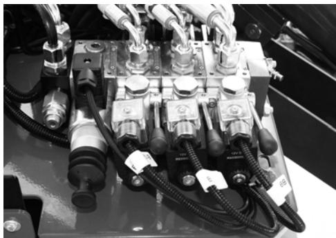
Fig. 143 Exemple des commandes sur le distributeur
