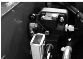
**Fig. 66** Déviateur manuel de pompe manuelle
