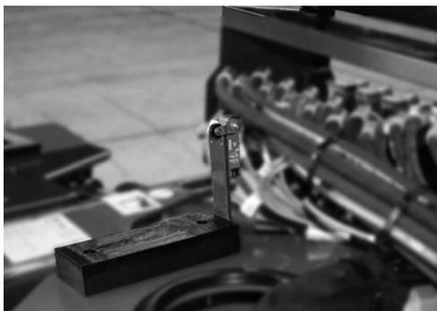
**Fig. 105** *Micro-interrupteur 1<sup>o</sup> bras*
