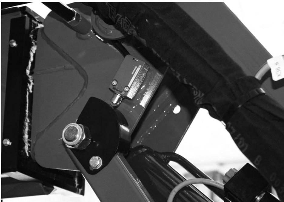
**Fig. 16** *Micro-interrupteur JIB*
