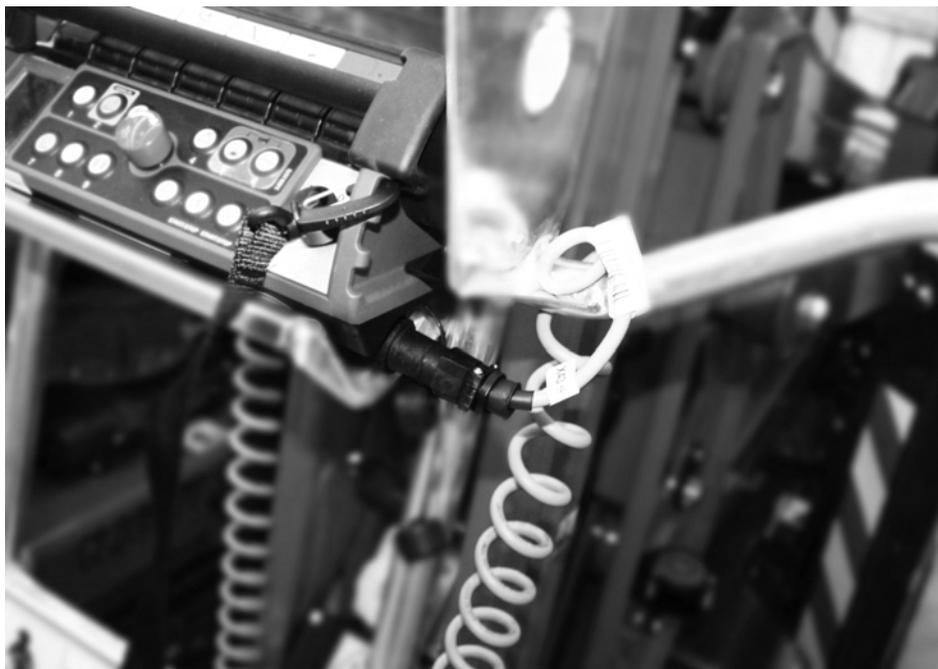
**Fig. 145** Connexion de la télécommande
