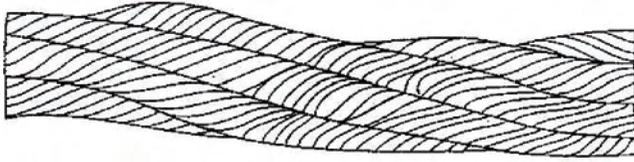
**Fig. 171** Exemple de câbles entortillés
