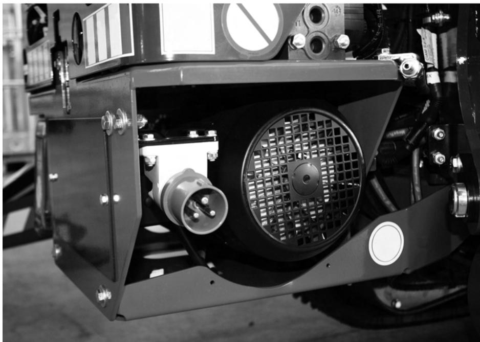
**Fig. 159** *Position du moteur électrique*
