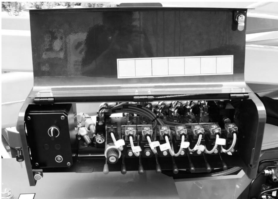
Fig. 75 Commandes sur le distributeur de la partie aérienne
