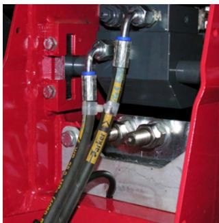
**Fig. 174** Écrous pour la fixation des câbles de sortie
