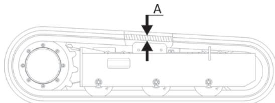
**Fig. 161** Contrôle de la tension des chenilles 2
