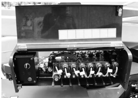
**Fig. 127** Commandes sur le distributeur
