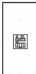
**Fig. 90** Erreur télécommande ou poids dans le panier
