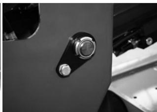
**Fig. 26** *Vis de blocage de la rotation*
