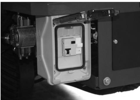
**Fig. 149** *Interrupteur automatique magnétothermique*
