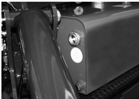
**Fig. 166** Indicateur du niveau d'huile hydraulique
