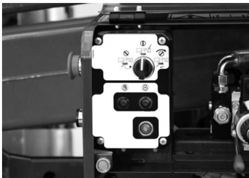
**Fig. 114** *Panneau de commande urgence sélecteur et boutons*
