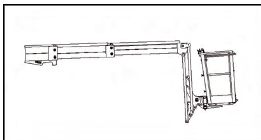
**Fig. 177** *Contrôle de l'usure des patins de l'élément télescopique*
