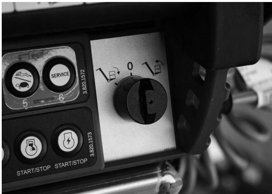
Fig. 107 Clé de mise à niveau du panier
