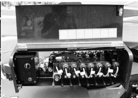
**Fig. 60** Commandes hydrauliques au sol
