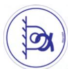
Les points de connexion des systèmes de fixation sont identifiés par l'autocollant.
