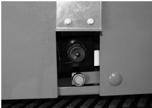
**Fig. 155** *Emplacement du connecteur de la deuxième télécommande en option*
