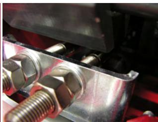
**Fig. 175** Extrémité avec logement pour la clé antirotation
