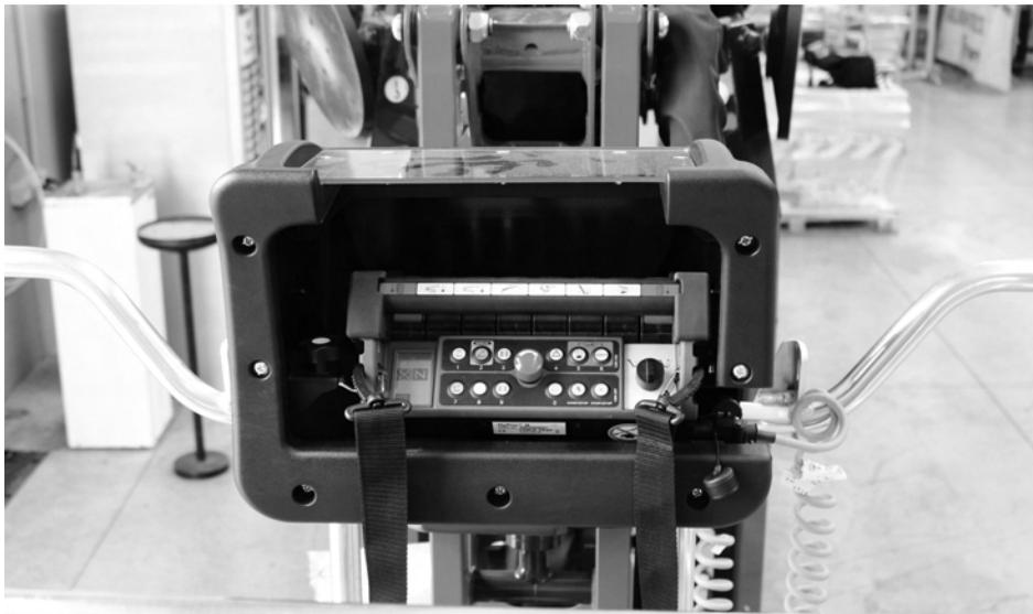
**Fig. 22** *Protection des commandes sur le panier*
