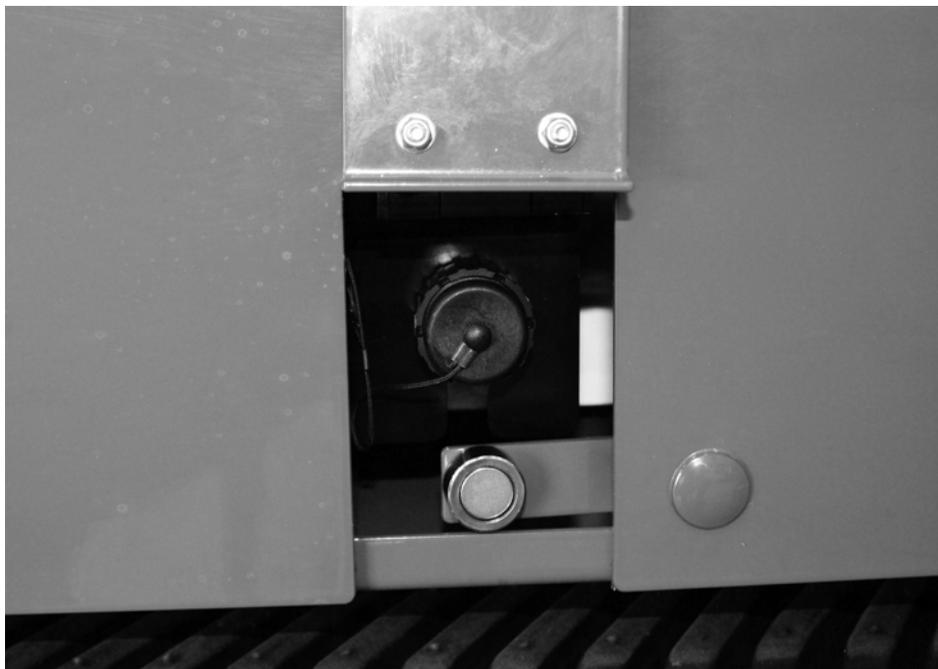
**Fig. 61** Emplacement du connecteur de la deuxième télécommande en option
