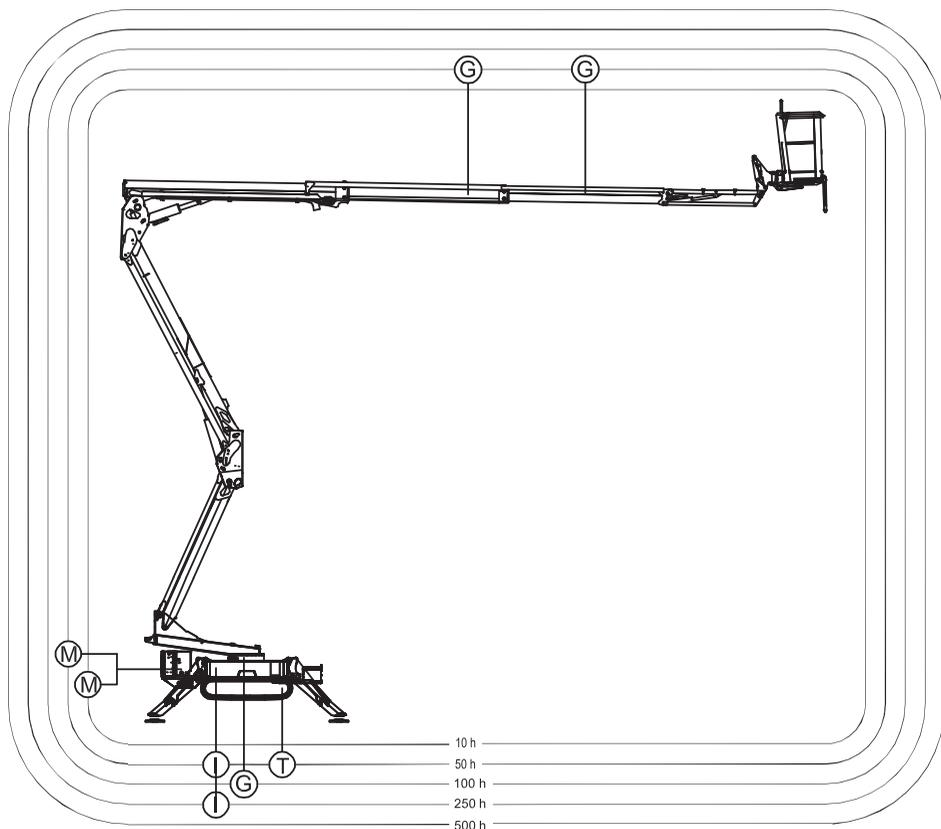
**Fig. 153** Schéma des points de graissage
