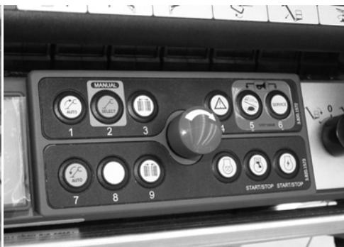
**Fig. 64** Bouton d'arrêt d'urgence sur la télécommande
