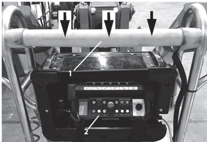
**Fig. 62** 1-Capteur SkyGuard™ 2- SkyGuard™ By-pass (bouton numéro 8)
