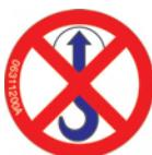
Interdiction d'utiliser ce point pour le levage
