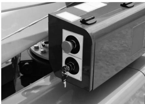
**Fig. 63** Bouton d'arrêt d'urgence sur le chenillard
