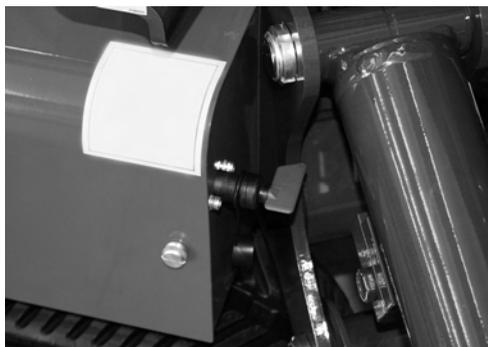
**Fig. 6** Coupe-batterie du moteur thermique
