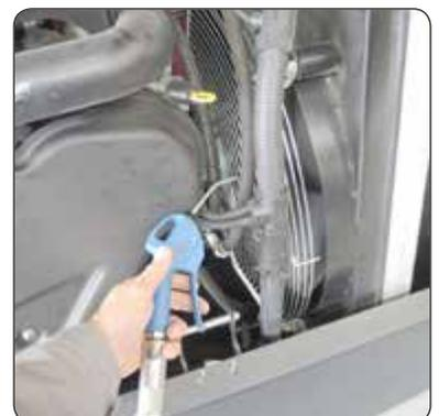
Dans le cas d'utilisation dans une atmosphère très poussiéreuse, il existe des éléments de préfiltration (≡ ÉLÉMENTS FILTRANTS ET COURROIES). De même la périodicité de contrôle et nettoyage de la cartouche doit être réduite.
