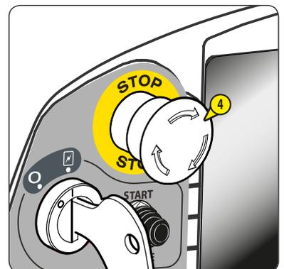
**Ne pas utiliser le bouton d'arrêt d'urgence dans le cas d'un arrêt simple de la nacelle. Sinon le réarmer aussitôt car aucune action sur le pupitre de commande au sol et le pupitre de commande panier ne peut être effectué.**
