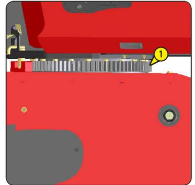
Nettoyer, puis graisser les points suivant avec de la graisse, (Voir chapitre "LUBRIFIANTS") et enlever le surplus.AXES
