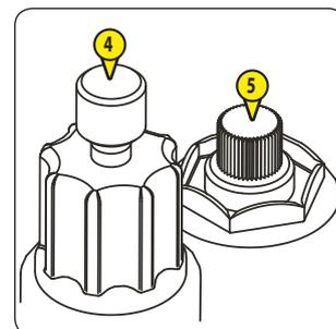
*Pour mettre les valves du distributeur au "neutre", tourner dans le sens anti-horaire la valve 4 et dans le sens horaire la valve 5.*
