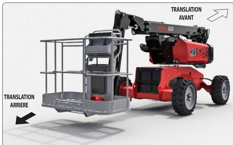
Mode travail: Un ou plusieurs bras de la nacelle sont levés et / ou le télescope est sorti. Dans ce mode, les translations se font en petite vitesse, les sécurités pour le dévers et la surcharge sont actives.
