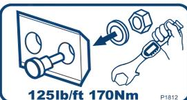
P1812  | Une clé dynamométrique calibrée doit être utilisée pour serrer les boulons à 125 pieds-livres (170 Nm).                                                                              |                                                                                              |
