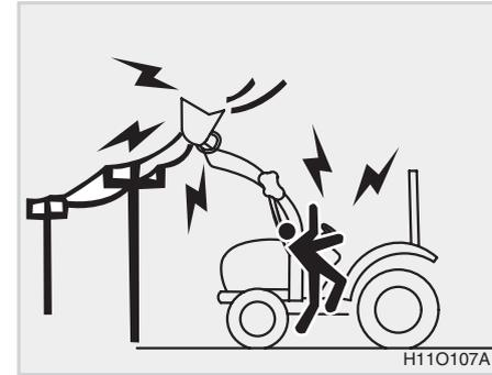
6. Ni les bras ni les outils du chargeur ne doivent entrer en contact avec de lignes électriques.
