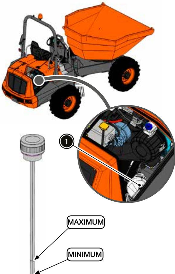
7. Retirez le bouchon (1) de remplissage d'huile du convertisseur de couple et de la boîte de vitesses.
