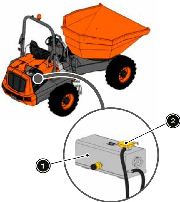
3. Procédez au remplissage du réservoir avec du liquide de refroidissement jusqu'à ce que le niveau soit entre le maximum et le minimum de l'indicateur (1).
