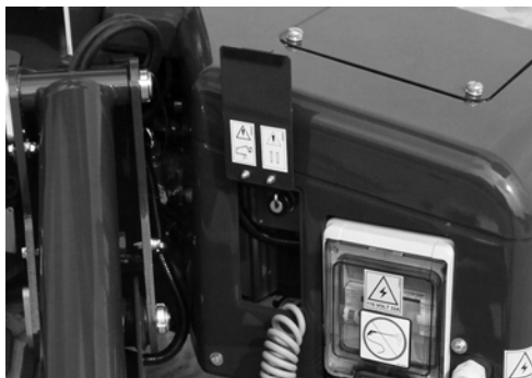
Fig. 131 Aansluitdoos in ruimte met elektrische componenten.
